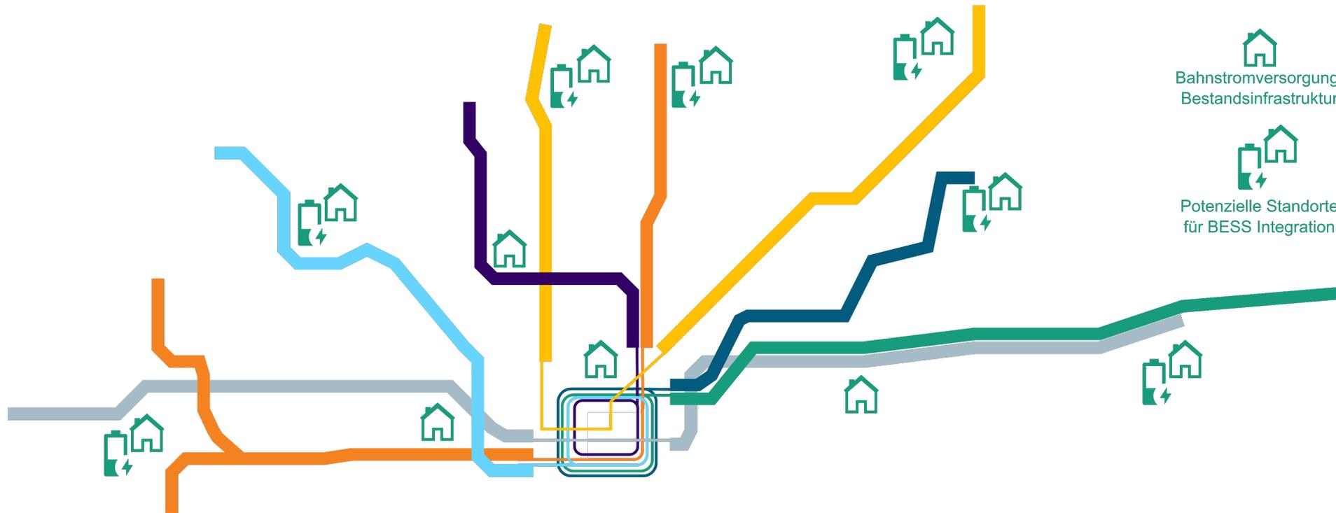
Die Rekuperation von Bremsenergie zusätzlich zum Energieaustausch zwischen den Fahrzeugen ist in einem Stadtbahnnetz mit sehr unterschiedlich hohem Potenzial möglich und erfordert den Einsatz von BESS.
